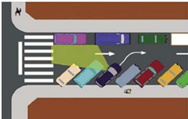
Figura 108. Estacionament en semibateria inversa
